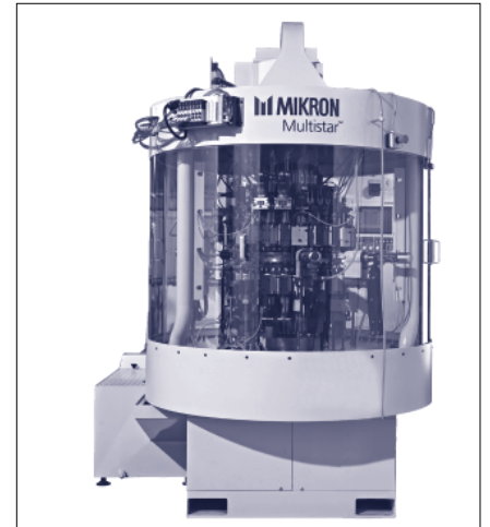
Der Schaltteller-Automat „Multistar“ für die Hochvolumenfertigung von Präzisionsteilen verfügt mit den neuen CNC Einheiten zusätzlich zur geforderten Produktivität und Präzision nun auch über die notwendige Flexibilität.
