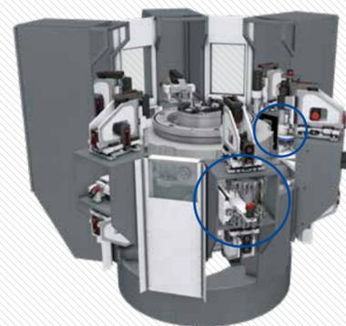
BIS ZU 168 WERKZEUGE UND 4 VERSCHIEDENE SPANNSYSTEME (HORIZONTALE UND VERTIKALE) AN BORD EINER MASCHINE
