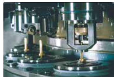
借助导向套加工
