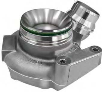
Kompressorgehäuse auf Mikron Multistep XT-200 55"/piece
