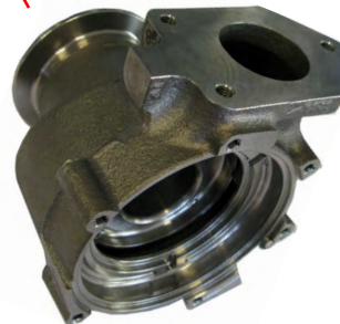
Turbinengehäuse auf Mikron Multistep XT-200 85"/piece
