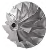
Verdichterrad auf Mikron Multistep XT-200
