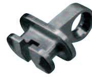
Eingebautes Scharnier: komplett gefertigt ab Draht auf einer NAM-8 Material CuNi18Zn20, 50 Stück/Min.
