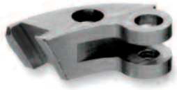
Gebogenes Brillenscharnier : komplett gefertigt auf einer NAM-8 Material CuNi18Zn20, 18 Stück/Min.
