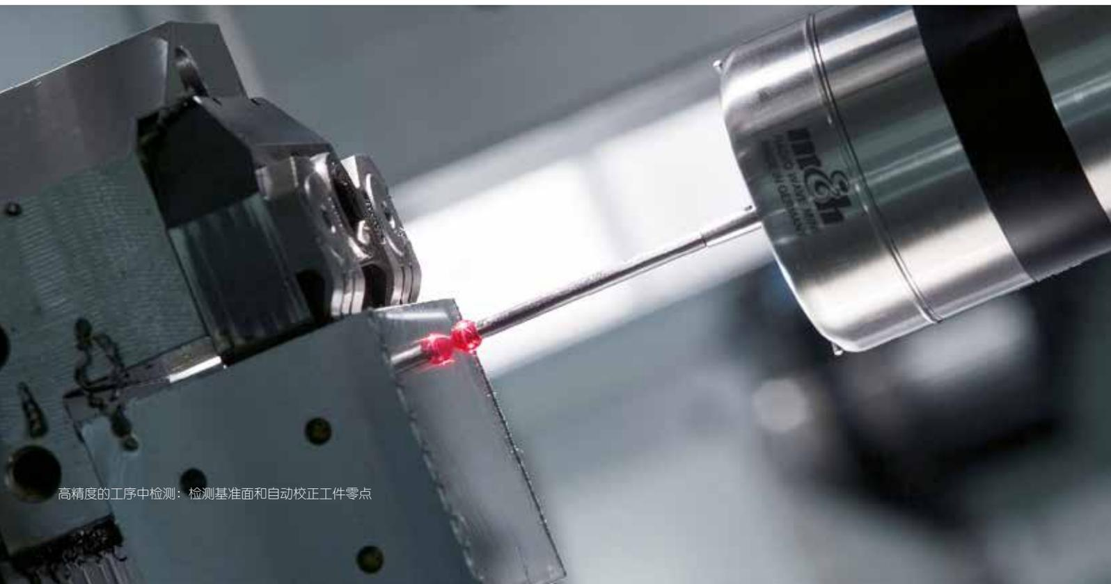
高精度的工序中检测：检测基准面和自动校正工件零点
